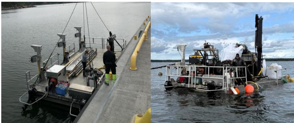
Figur 7: Fotografier av den nya Ecopelag-skördaren, med kapstaner och stjärnhjul monterade på en aluminiumpråm. Till vänster: nyss levererad från varvet. Till höger: i drift. Skördeutrustning från Bakker förvärvades från det tidigare EU-projektet Baltic Blue Growth, monterades på den nya skördepråmen och kompletterades med en specialutformad musselsorterare/musselvtätt
