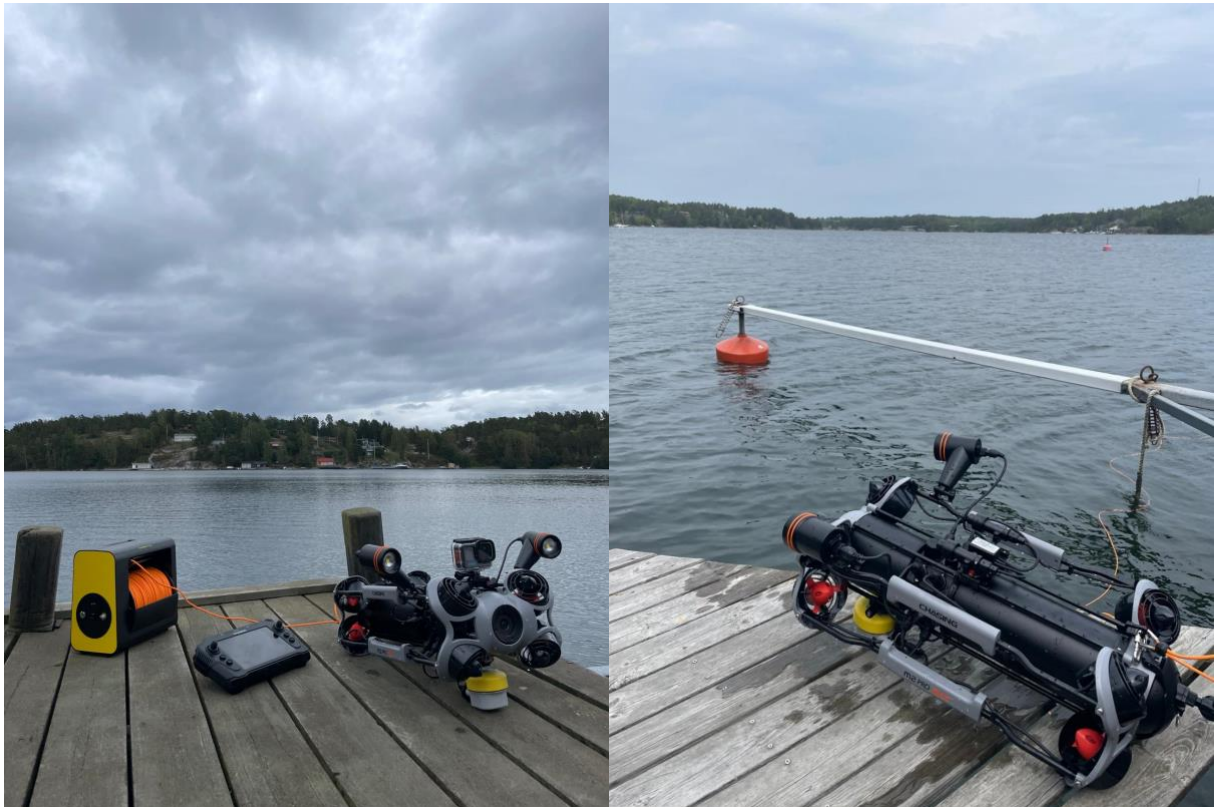
Figur 11: Vänster: Drönare med GoPro-kamera monterad på ovansidan och distanssonar monterad under drönaren samt handhållen skärm med kabeltrumma (E-reel). Höger: Drönare med laser monterad på ovansidan. Bilderna är tagna vid testmontering och -körning av drönaren i en vik.
