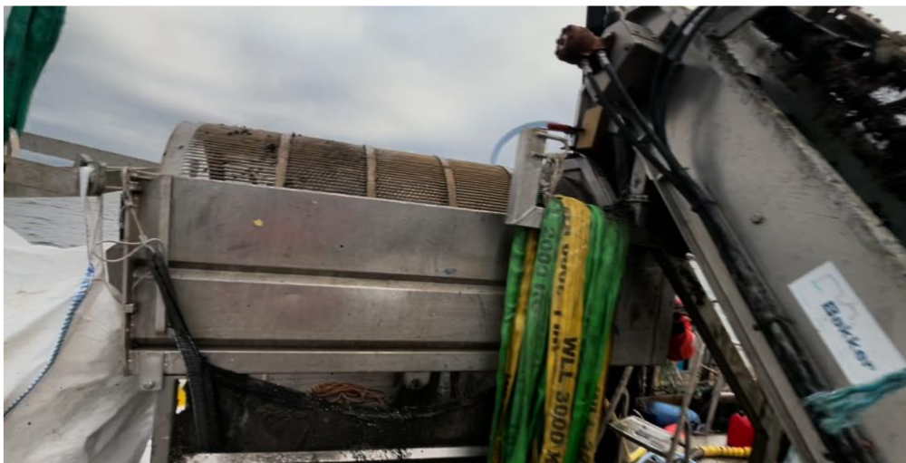
Figur 9: Större musslor stannar kvar i den roterande trumman och spolats vidare till uppsamlings säck (vit), medan små musslor åker genom gallret och samlas upp i en svart nätpåse som är monterad under sorteraren.
