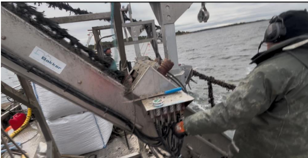
Figur 8: Två personer arbetar tillsammans på skördaren. Den ena opererar maskineriet, medan den andra ansvarar för att kapa loss substratlooparna från bärlinan och mata dem genom skördaren där musslorna skrapas av. Det tomma substratrepet återfästs därefter som loopar på bärlinan, och musslorna förs vidare till sorteraren/tvätten.
